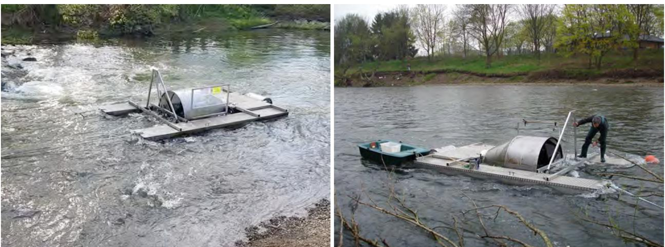
Abbildung 7-2. Rotary Screw Trap (Smolttrommel) in der Agger in Nordrhein-Westfalen, Deutschland (Photos © Limnoplan).
